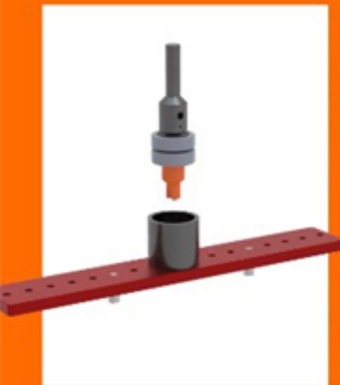
Die Schablone kommt immer dann zum Einsatz, wenn nachträglich eine Bohrung für die Dübelklemme exakt platziert werden soll. Sie ermöglicht präzise Lochpositionen ( 32mm Rasterabstand ) und sorgt für wiederholgenaue Ergebnisse – ideal für die passgenaue Nachrüstung oder Korrektur bei der Montage von Dübelklemmen.
